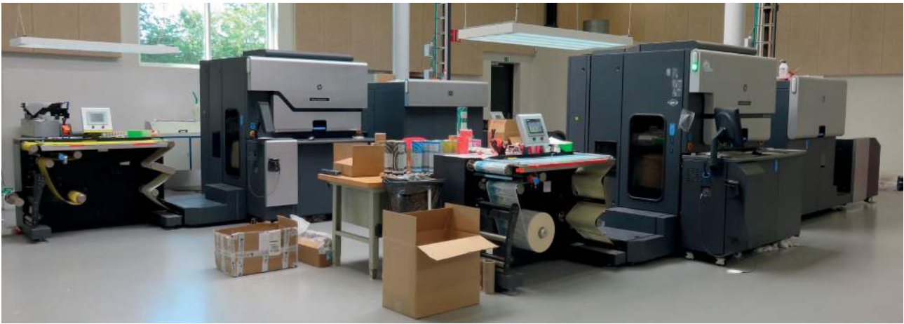
De to HP Indigo-presser hos 4LABELS. Den bageste er født som WS6600, men er senere opgraderet softwaremæssigt til WS6800. De to maskiner kan nøjagtig det samme bortset fra digitalt sølv, så kapaciteten er fordoblet. Og så er produktionsprocessen miljøvenlig
